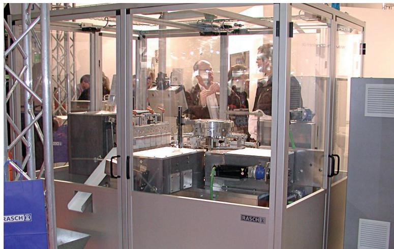
Abbildung 4: Die Rasch-Wickelmaschine Type RU 2 bei ihrem ersten öffentlichen Auftritt auf dem ProSweets-Messestand von Wilhelm Rasch Anfang des Jahres in Köln und links die Glättstation mit Produktschütze zum Band.
